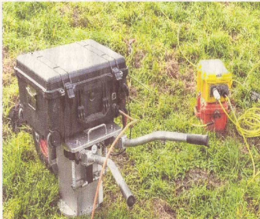
Die seismische Vibratorquelle, mit der in der Krempermarsch der Untergrund untersucht wird, ist so groß wie eine Schubkarre.
