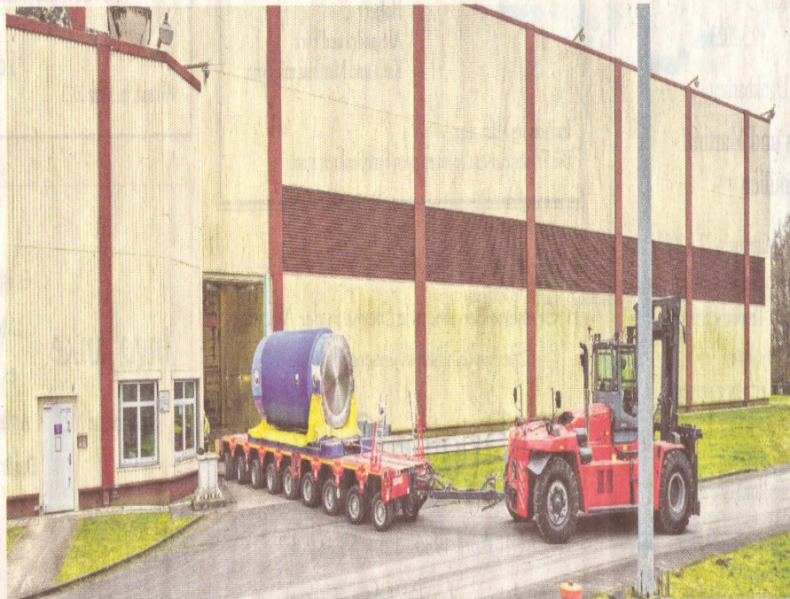
Der Castor-Behälter wird in das Brennelemente-Zwischenlager Brokdorf eingefahren.
