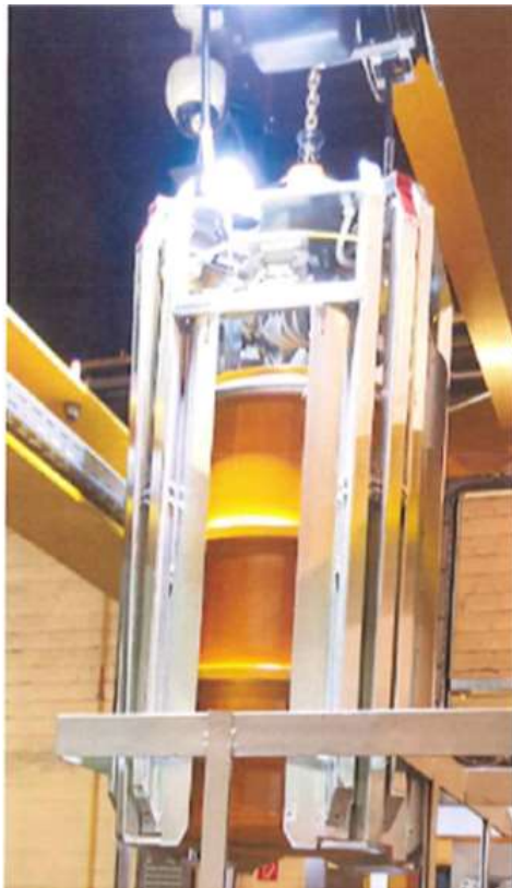
Der Umfanggreifer (kann stark beschädigte Fässer umschließen) ebenfalls mit Bodenklauen (© KKB)
