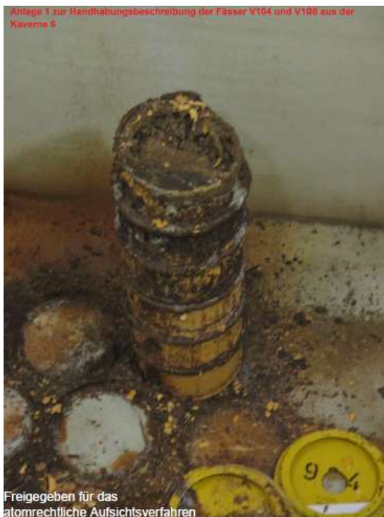
Fass V104 mit abgerissemem Deckel nach dem Umsetzversuch und vor der Bergung mit dem Umfanggreifer (© KKB)
