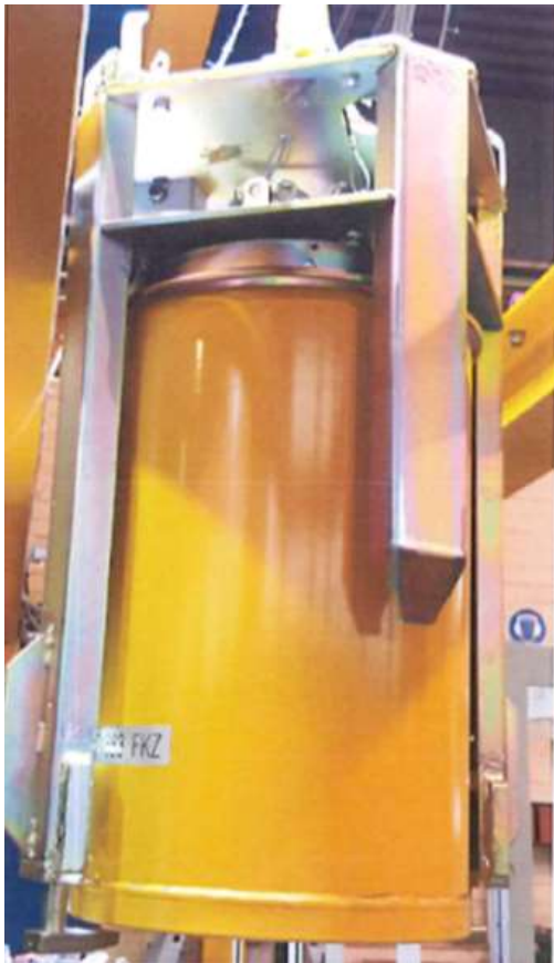
Der Unterschwenkgreifer (auch Deckel – Boden – Greifer genannt) (© KKB)
