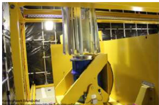
Aufgerichtetes Fass mit Deckel-Boden-Greifer (© KKB)
