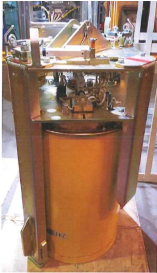
Der Unterschwenkgreifer (auch Deckel – Boden – Greifer genannt) (© KKB)
